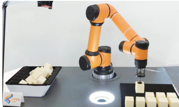
AUBO-i5 3D视觉分拣码垛应用
