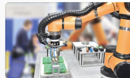
AUBO-i5 PCB板元件插装应用
