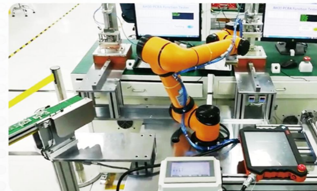
AUBO-i5 PCBA检测上下料应用
