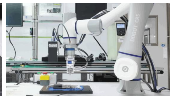
3D 视觉系统引导 (精度 \pm 0.2 \mu\text{m} )
